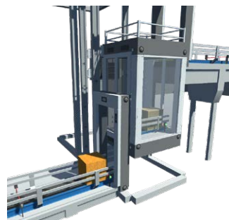
Banda transportadora y elevador
