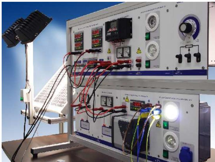
El equipo HRE-EN 01.5 permite estudiar, tanto instalaciones de energía solar fotovoltaica aisladas, como de conexión a red. El equipo consta de: 2 paneles fotovoltaicos de 20Wp, 2 baterías, regulador, inversor de aislada, inversor de conexión a red, emulador de paneles solares, piranómetro, distintas cargas en corriente continua y alterna, y módulo de control y adquisición de datos.
