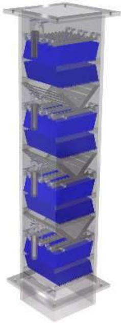
La torre HRE-TC 02.6, se presenta como una torre de 8 niveles y 19 paneles por nivel, con sensores de temperatura en 3 puntos.
