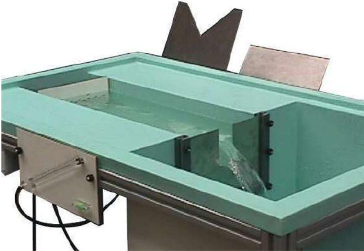
Se emplea el canal incorporado en la superficie del banco hidráulico (no incluido), para lo cual se suministran placas vertederos de diferentes formas que se acoplan en el mismo.
