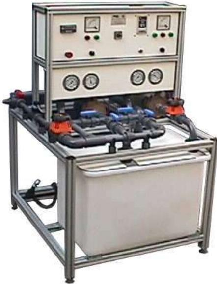
Con este equipo se pueden practicar gran parte de las operaciones, tanto de puesta en marcha, como de funcionamiento y regulación necesarias en una instalación de bombeo.
