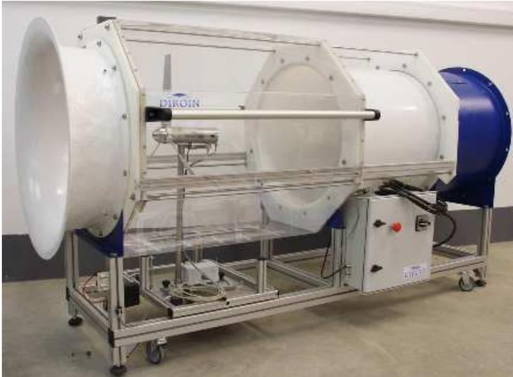
Tunel fabricado sobre estructura de aluminio anodizado y policarbonato transparente de 2 metros de longitud y 700mm de diámetro interior.
