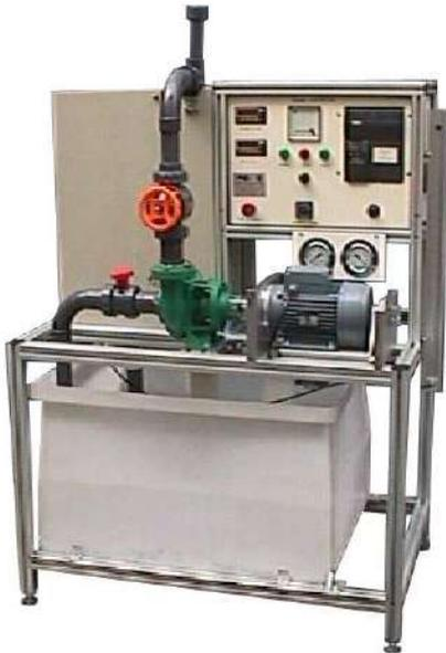
Este equipo está diseñado para realizar gran parte de las operaciones, tanto de puesta en marcha como de funcionamiento y regulación necesarias en una instalación de bombeo.
