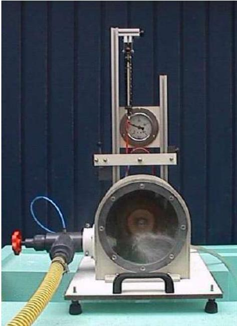
Equipo diseñado para el estudio y visualización tanto del comportamiento como de las características de una turbina Pelton.
