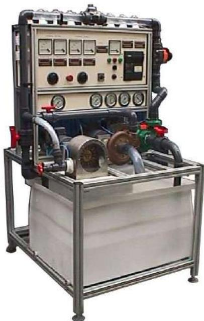
Equipo muy completo con el que se pueden analizar y estudiar aspectos tales como operaciones de puesta en marcha, control de funcionamiento y regulación, necesarias en una instalación de bombeo, así como estudio de las características de una bomba funcionando de forma individual, o de dos tipos diferentes de turbinas, Pelton y Francis.
