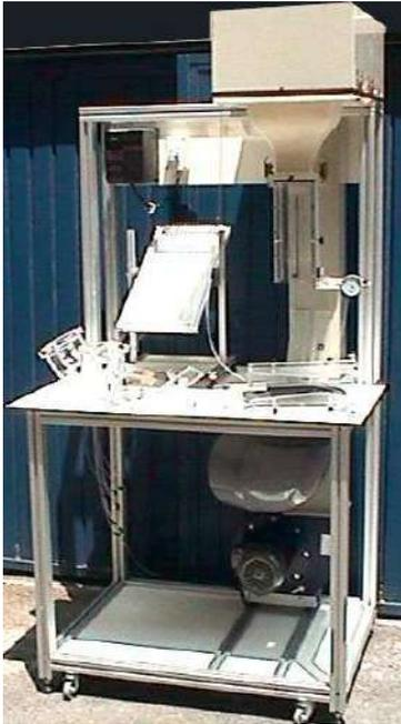
El banco de aerodinámica está diseñado para la realización de una gran variedad de experiencias en el campo de la mecánica de fluidos, utilizando para ello una corriente controlada de aire.
