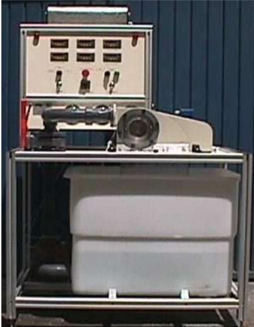
Este equipo ha sido diseñado para el estudio de las características de una bomba centrífuga, de una turbina de flujo cruzado y de ambas a la vez obteniendo el rendimiento total del conjunto.
