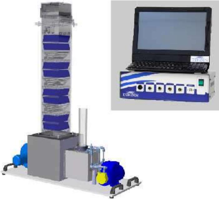
El HRE-TC 02.1, muestra un método de refrigeración habitual en industria. Este método consiste en enfriar el agua caliente hasta la temperatura ambiente.
