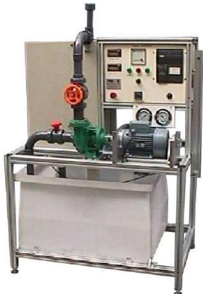
Este equipo está diseñado para realizar gran parte de las operaciones, tanto de puesta en marcha como de funcionamiento y regulación necesarias en una instalación de bombeo.
