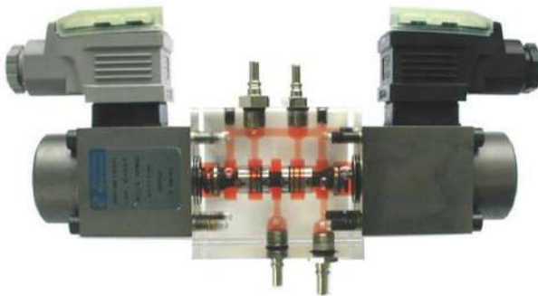
Distribuidora proporcional 4/3 Válvula distribuidora 4/3 de accionamiento directo por bobinas proporcionales. Centrada por muelles A, B y P unidos, T cerrado en posición central Ref.13020532
