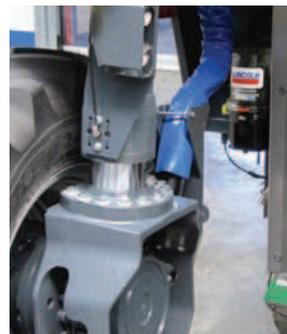
Los componentes de las máquinas vendimiadoras están expuestos a cargas de alta vibración y necesitan una lubricación confiable todos los días que se utilizan. Los sistemas de lubricación automática ProFlex de SKF y Quickclub de Lincoln ayudan a ahorrar tiempo para dedicarlo a otras tareas en la elaboración de vinos. Los lubricadores automáticos
